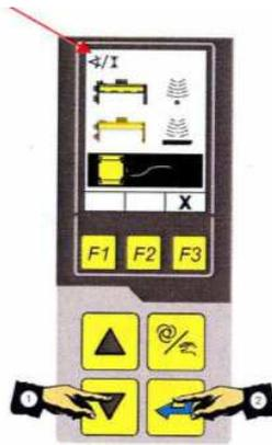
上げ/下げキーでセンサを選択、確定キーでセンサを決定します。
